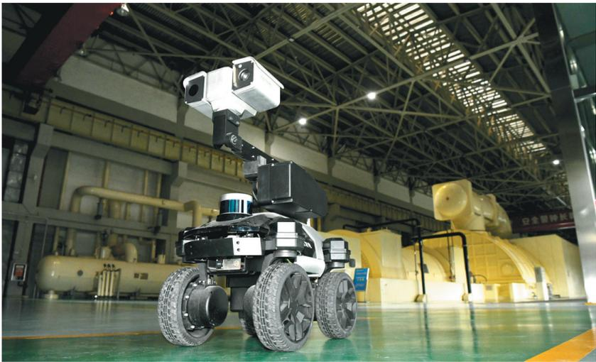
近日,在商洛发电有限公司汽轮机房区域,只听到机器转动的轰鸣声却看不见值守人员,只见一辆智能巡检机器人忙碌地穿梭于机房内。它根据检测作业要求,对生产区域的设备、仪器仪表等设备进行多场景的数据采集、读取和检测,并通过5G网络技术进行实时监控分析和预警工作,实现了发电巡检工作的安全、智能、高效。 □本报记者 刘强 摄
