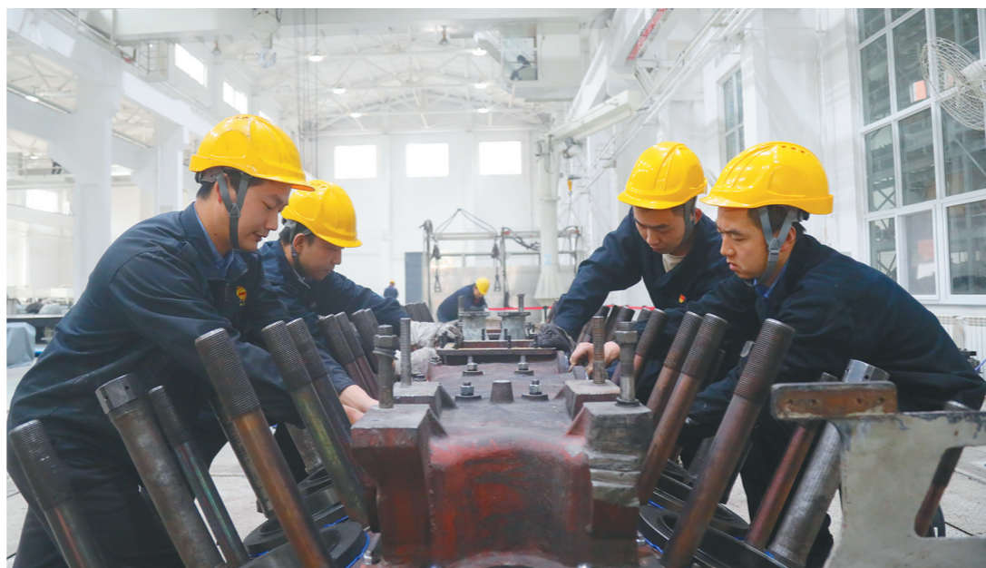
进入冬季,机车油、水、风等管路“跑、冒、滴、漏”问题多发。为了确保铁路运输万无一失,国铁西安局宝鸡机务段检修厂紧盯机车车防措施落实,全面排查各类管路状态并做好防寒带捆扎工作,检查更新管路接口、阀门等关键部位密封圈等,让机车“温暖过冬”。图为该厂职工对柴油机车机体进行全面整修维护。
