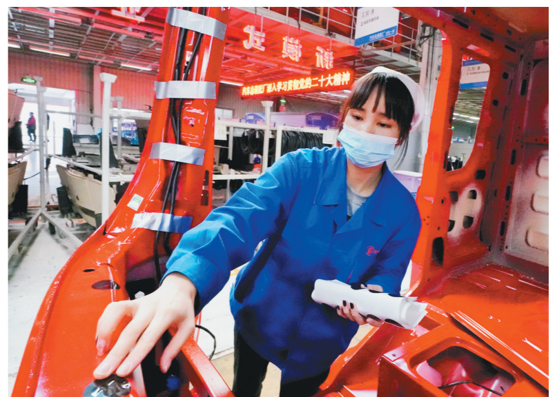
陕汽控股集团有限公司汽车总装厂在做好疫情防控的同时,及时调整生产组织方式,保障订单正常交付。图为内饰装调工为驾驶室安装防水堵贴。 张俊妮 摄
