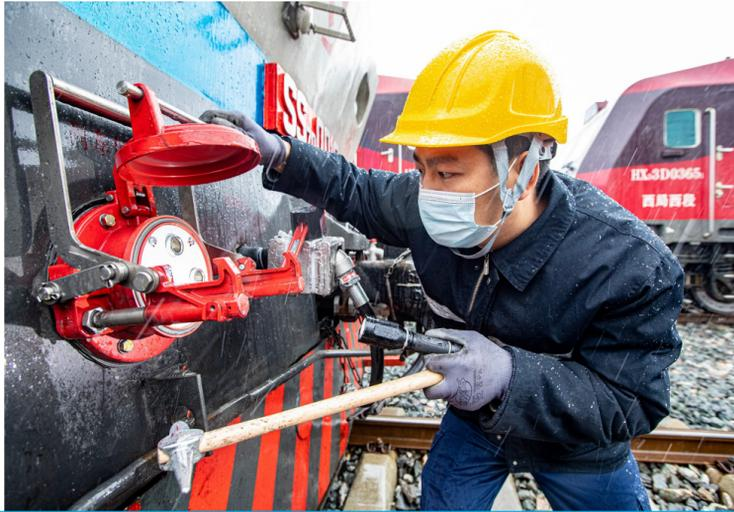
→12月25日,西安迎来雨雪天气,国铁西安局西安机务段全面开展机车隐患排查,为旅客安全出行保驾护航。图为检修工人检查列车供电插座状态。 曹欣 摄
