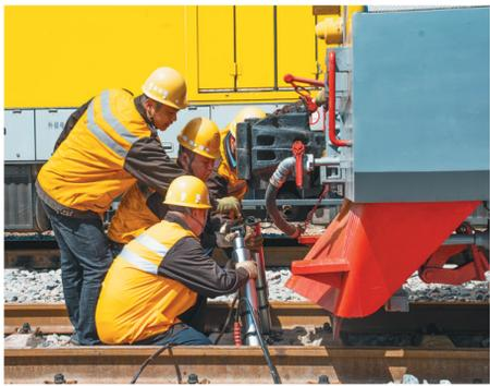
为确保轨道作业车运行安全,4月14日,国铁西安局宝鸡供电段组织开展2023年轨道车起复应急演练,进一步筑牢班组轨道车司机安全生产意识。
