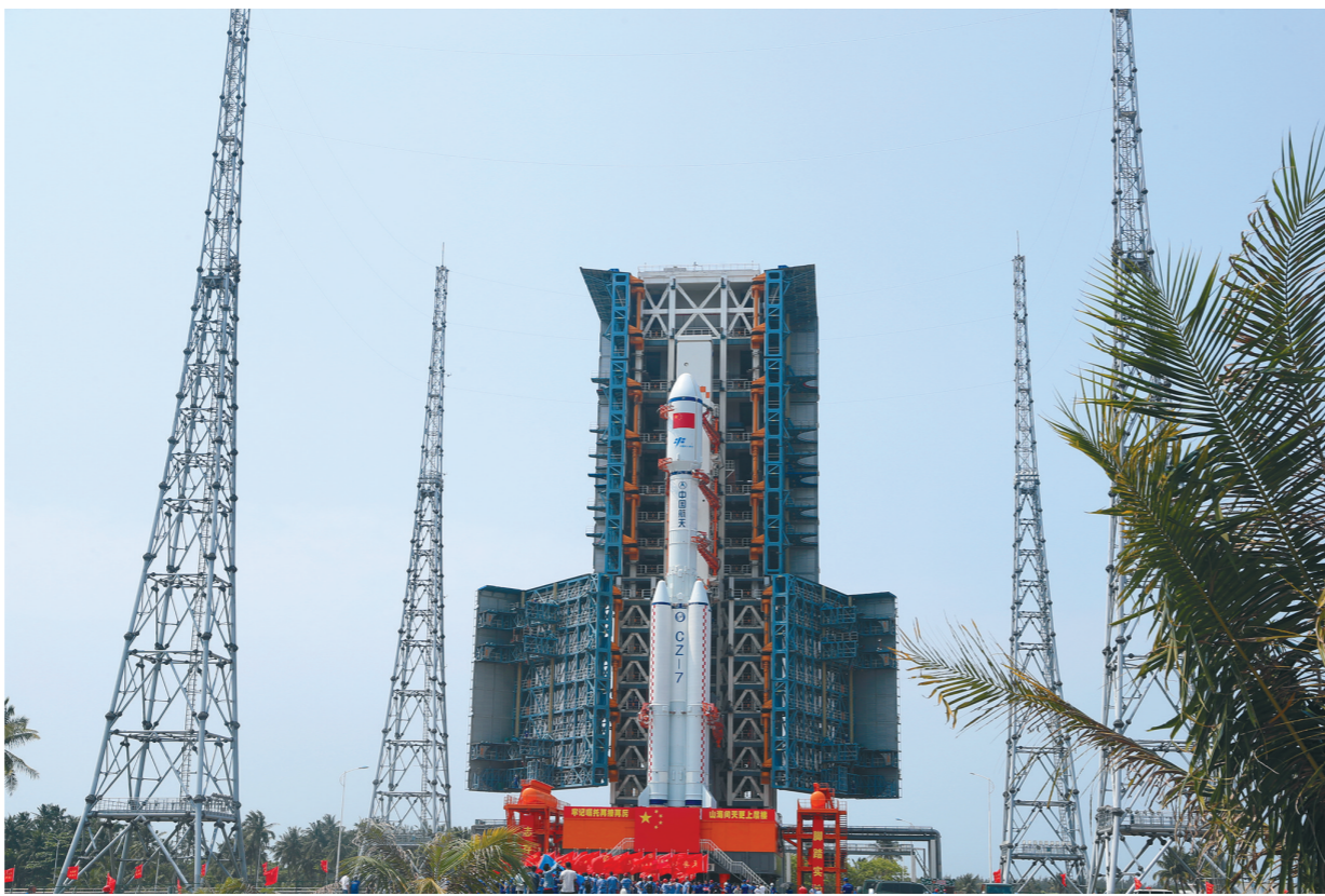
天舟六号货运飞船与长征七号遥七运载火箭组合体5月7日垂直转运至发射区,计划于近日择机实施发射。
