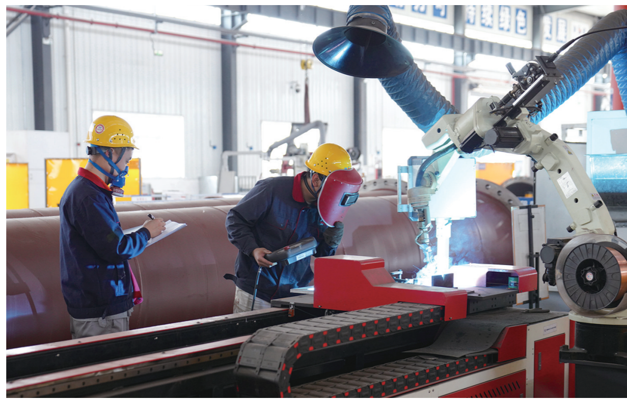
近期,陕建八建集团应用智能加工设备二十多天就完成了西安咸阳国际机场三期扩建工程多个焊接项目,在既定节点前完成第一批交付任务。图为工人利用数控焊接机器人进行支架焊接。 □陈玺龙 摄
