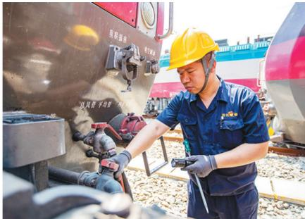
近日,西安及周边地区持续高温,国铁西安局西安机务段生产一线职工迎战酷暑,在烈日下对客运机车进行精心检查和整备工作,确保旅客列车运行安全有序。图为该段职工检查列车车闸门状态。 曹欣 摄
