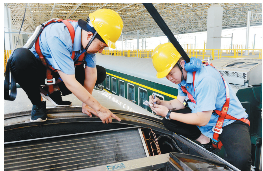
入伏以来,我省多地气温不断攀升。国铁西安局西安客车车辆段持续做好配属客车空调、电扇等防暑降温设施
