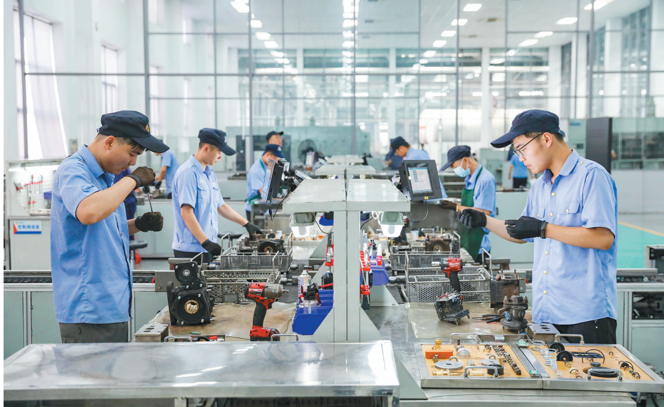
连日来,国铁西安局西安东车辆段深入推进标准化、规范化建设,围绕“生产管理、安全管理、技术管理、岗位管理、作业管理、环境管理”六个方面检查分析,建立班组自我管理机制和 workflows,提高自主管控能力,提升现场管理水平。图为8月7日修配车间内制动班职工进行制动阀组装作业。 □杨凯帆 摄
