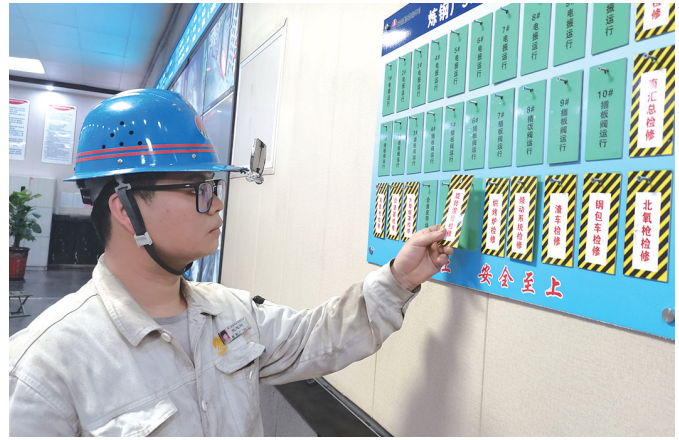
8月21日,陕钢集团龙钢公司炼钢厂转二作业区5#炉操作室内,检修人员将操作牌翻转至检修状态。
