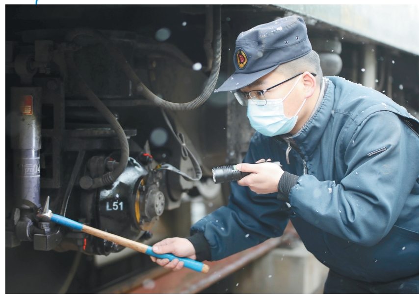
2月21日,中国铁路西安局集团有限公司西安客车车辆段积极应对雨雪天气,组织技术力量加强对旅客列车的检查维护,确保列车运行安全。图为检车员正在检查列车走行部。通讯员 赵伯顺 摄
