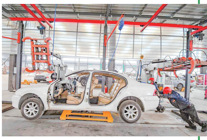
工作人员配合翻转机对拆解车辆进行移动。
