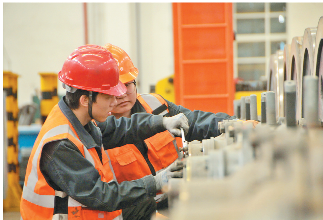
3月以来，中铁一局集团新运公司准格尔铁路公司紧抓煤炭运输黄金阶段，统筹做好春季施工期间行车安全卡控与运输组织工作，不断优化行车方案，强化机车设备检修，充分保障运输保供任务安全高效进行。图为3月31日员工对机车轮对部件进行检修。 □通讯员 刘顺良 谭帅 摄
