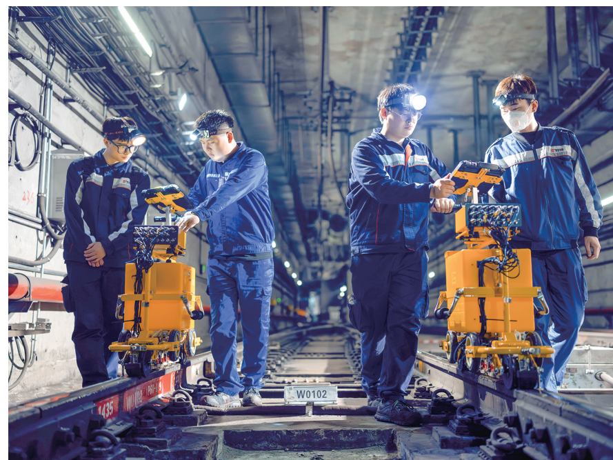
连日来,西安市轨道交通集团运营分公司探伤专业开展正线钢轨探伤工作,对钢轨母材、接头焊缝、道岔等设备进行伤损检查,确保及时发现并处置伤损隐患。图为4月8日凌晨,探伤工进行钢轨探伤。 □通讯员 李嘉彬 摄
