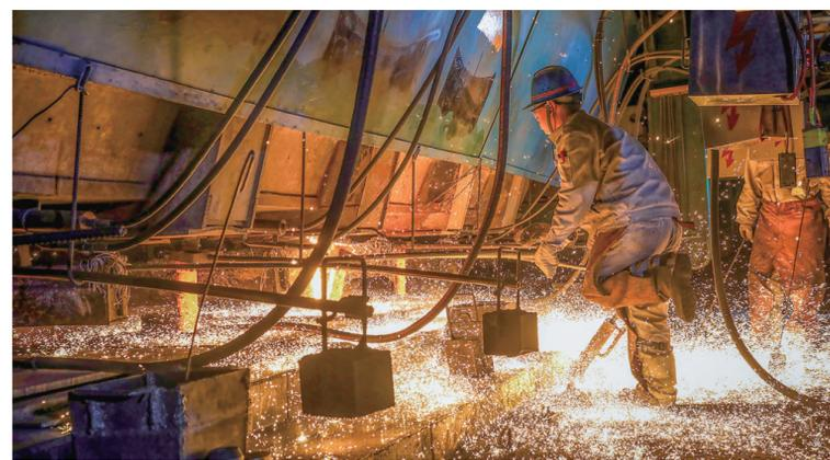
2021年10月26日,陕钢龙钢公司炼钢厂一名中包工正在更换浸入式水口。孙超超 摄
