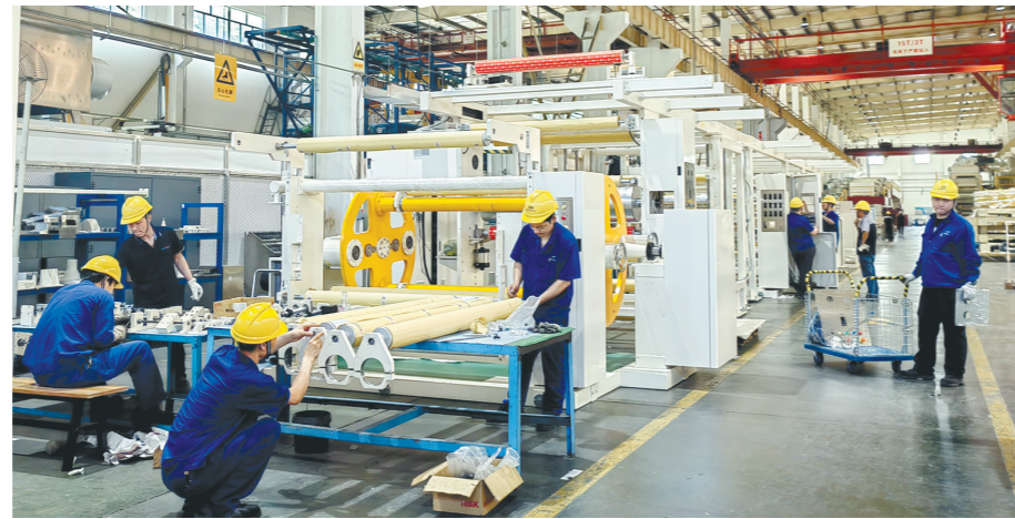
装配工人正在安装涂布设备。
