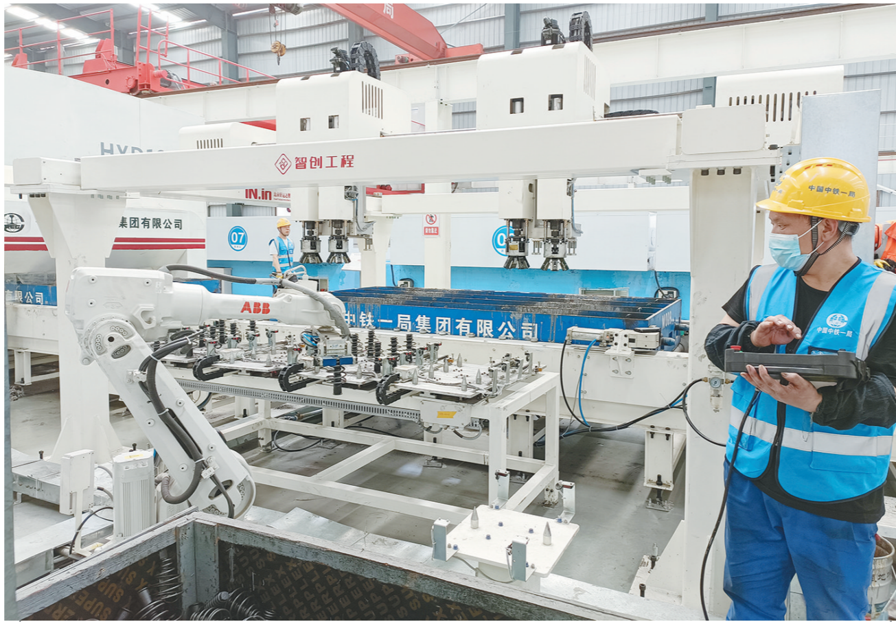
8月8日,在中铁一局西成高铁建设工地的智能轨枕生产线上,工人正在操纵着数控钢筋焊接全自动进行作业。据悉,中铁一局西成智能轨枕厂7000平方米的智能化、自动化生产车间仅10名作业人员,他们一天就能生产1600根标准的高铁双块式轨枕,西成高铁甘肃段183.2公里的全部轨枕都在这里生产。西成高铁智能化轨枕厂改变了传统生产线的固有模式,是当前国内最先进的轨枕智能化生产线。 □通讯员 彭卫泉 摄
