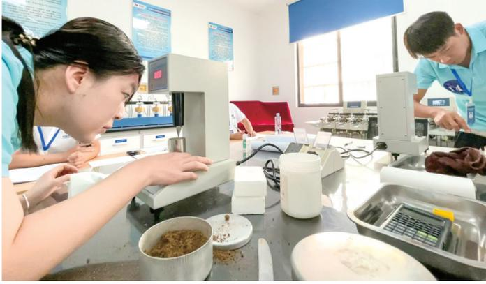
参赛选手进行土壤液限联合测定试验。
