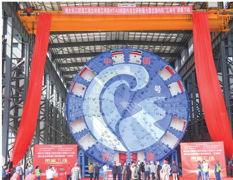
10月31日,国内自主研发、最大开挖直径达16.64米的超大直径盾构机在湖南长沙下线,将被用于目前全国最长公路水下盾构隧道——海大长江隧道施工。这台盾构机取名为“江海号”,由中国铁建重工集团、中铁十四局集团联合打造,整机长约145米,总重量约5000吨。
