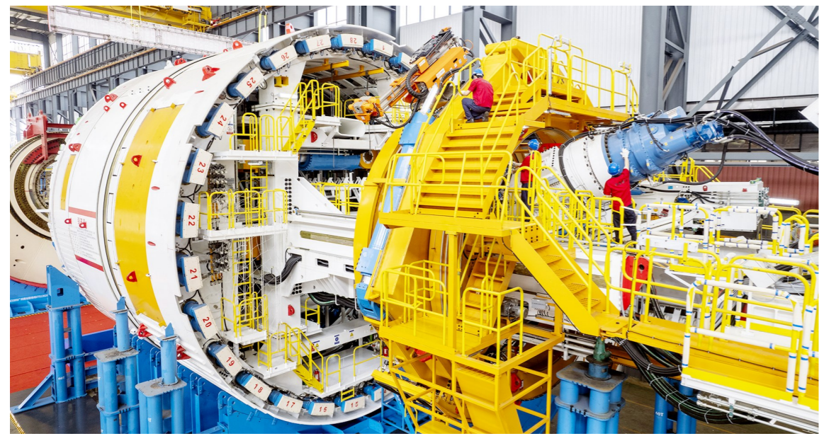
3月26日,工人在铁建重工长沙第二产业园调试“强基号”掘进机(无人掘进机)。
