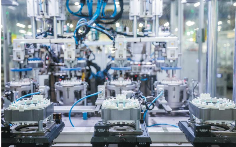
4月2日,位于浙江省湖州市吴兴区织里镇的浙江永昌电气股份有限公司数字化车间内,自动化流水线在生产直流变频电机。该公司是一家专业研发、生产、销售各类高效、节能电容感应电机、直流变频电机和新能源汽车电机的国家高新技术企业和国家专精特新“小巨人”企业。
