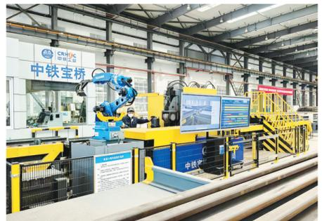
“五一”前夕,中铁宝桥道岔公司“数智化工厂”建成投用。图为工人正在百米钢轨下料全自动生产线上操作。
